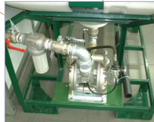
Montaggio di Pompa e Filtro sul Siletto
