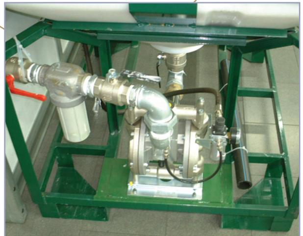
Montage de Pompe et Filtre sur le Siletto
